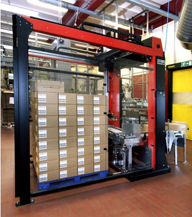
Robot-In-A-Box – fylder ikke meget mere end en palleplads og derfor særligt attraktiv, hvor pladsen er trang.
