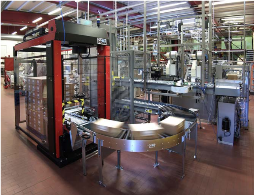
Robot-In-A-Box – enkelt og naturligt integreret i Merrild Kaffes strømlinede pakkelinie.
